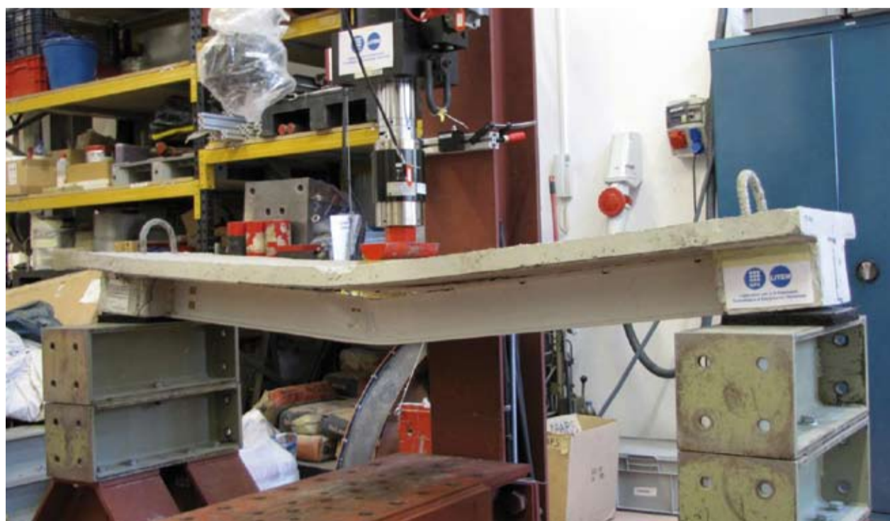
Nueva aplicación de vigas mixtas de material compuesto y hormigón
