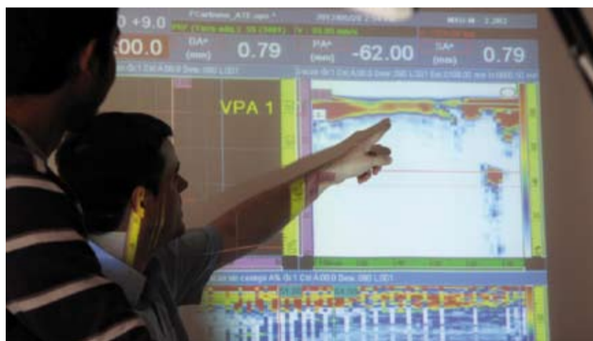
Mapa de inspección ultrasónica con phased-array de un stringer
